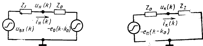
Рис. 2.1. Эквивалентные схемы для расчета режима на концах линии передачи.
